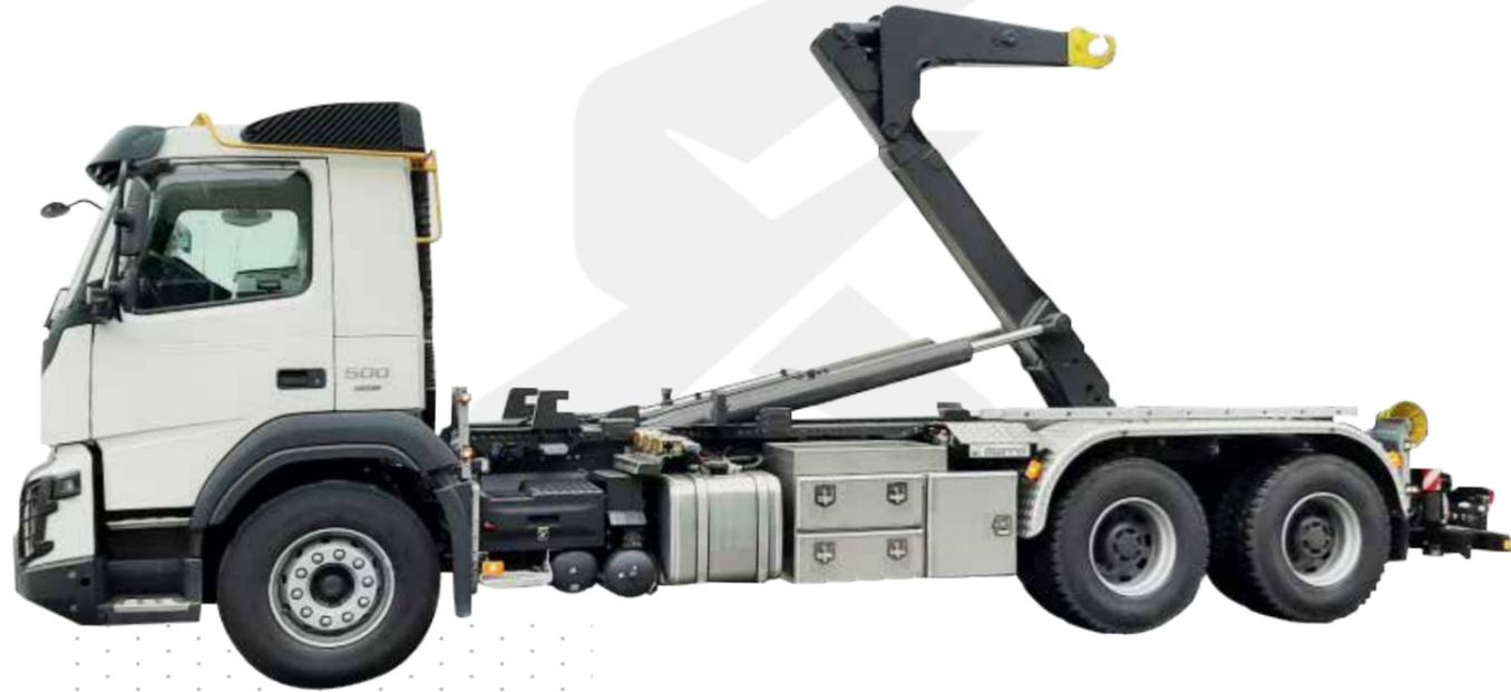
El **brazo telescópico y articulado**, combinado con la bieleta retráctil Marrel, permite reducir el ángulo de carga hasta 10° para obtener la máxima eficacia.
