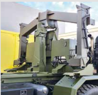
Cadre stocké - twistlock avant H frame stored - Front twistlock
