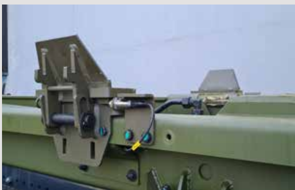
Centreur repliable pour plateau Flatrack foldable centering
